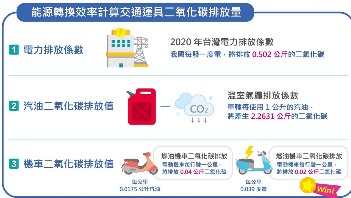
圖、能源轉換效率計算交通運具二氧化碳排放量
